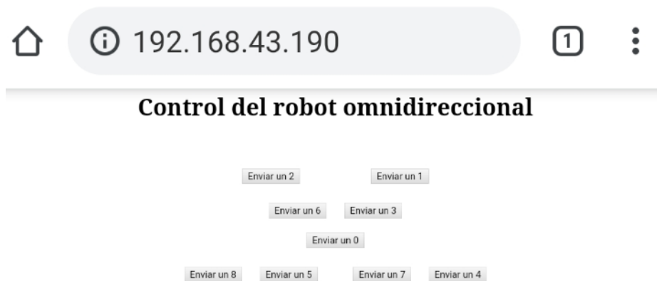
Figura 104. Vista en teléfono móvil del control del robot mediante servidor web en Arduino MEGA
