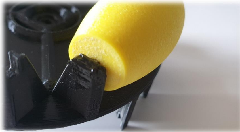
Figura 87. Fijación de la unión entre los rodillos y la estructura de la rueda omnidireccional
