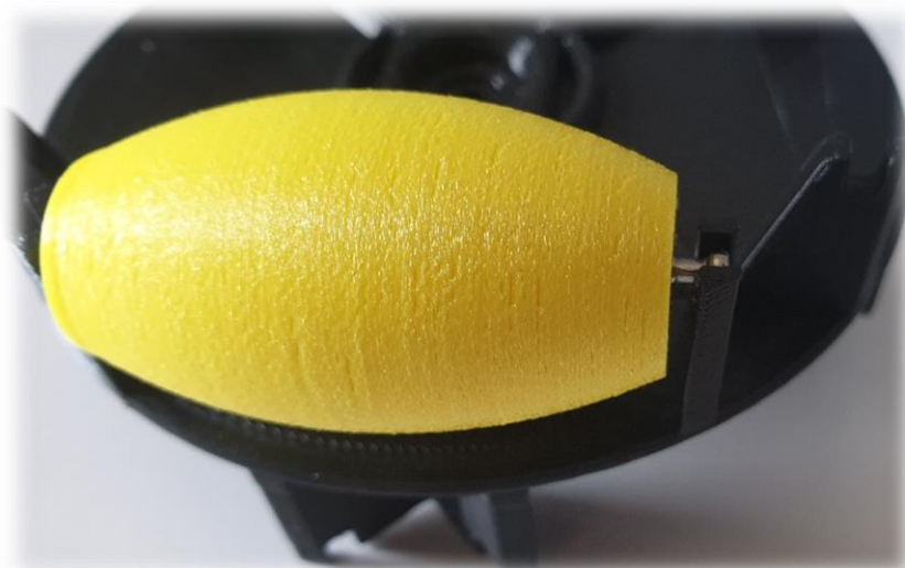
Figura 86. Colocación de los rodillos en sus soportes
