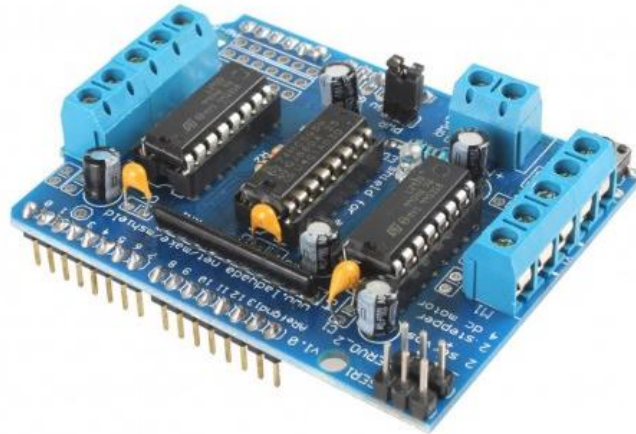
Figura 26. Placa de conexiones del L293D
