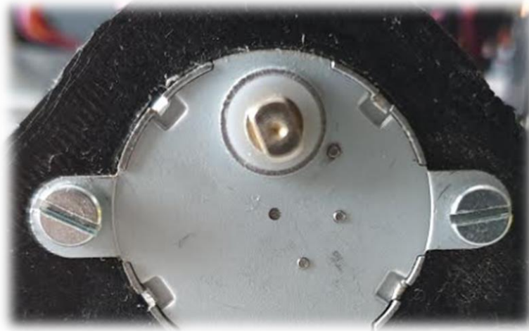
Figura 89. Incorporación de tornillos para sujetar los motores paso a paso
