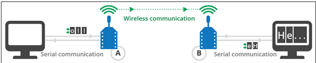
Imagen 1: Descripción gráfica de la comunicación entre dispositivos XBee y otros dispositivos. [3]
