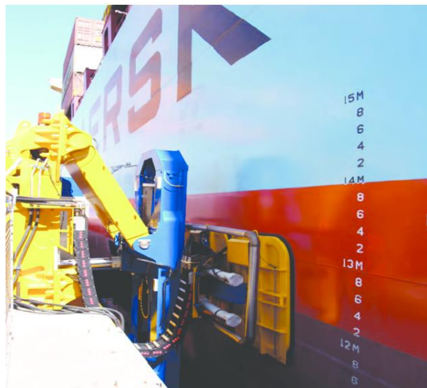
Imagen 7. Sistema de amarre por vacío.
