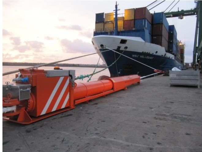
Imagen 8. Sistema de amarre “Shoretension”.
