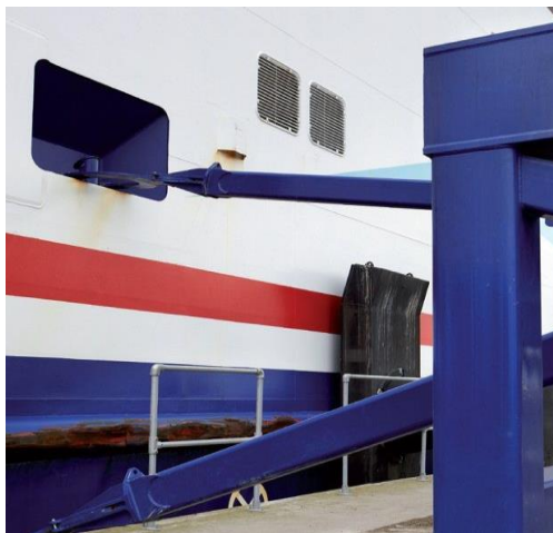
Imagen 5.Sistema de amarre semiautomático. TTS Marine.
