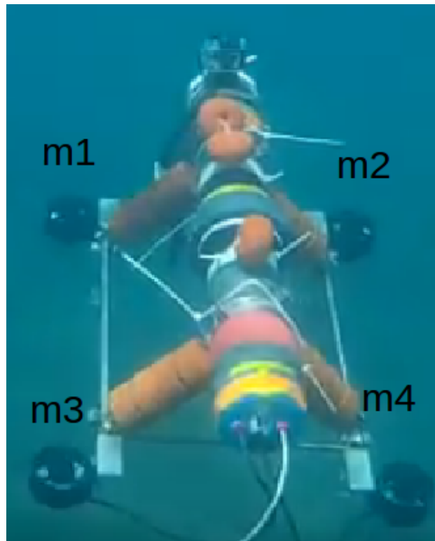
Figura 4.20: Disposición de los motores en el ROV
