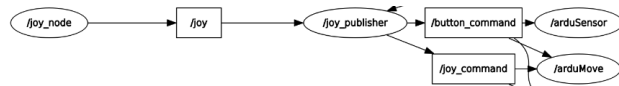
Figura 4.18: Esquema de nodos y tópicos involucrados en el sistema de control manual
