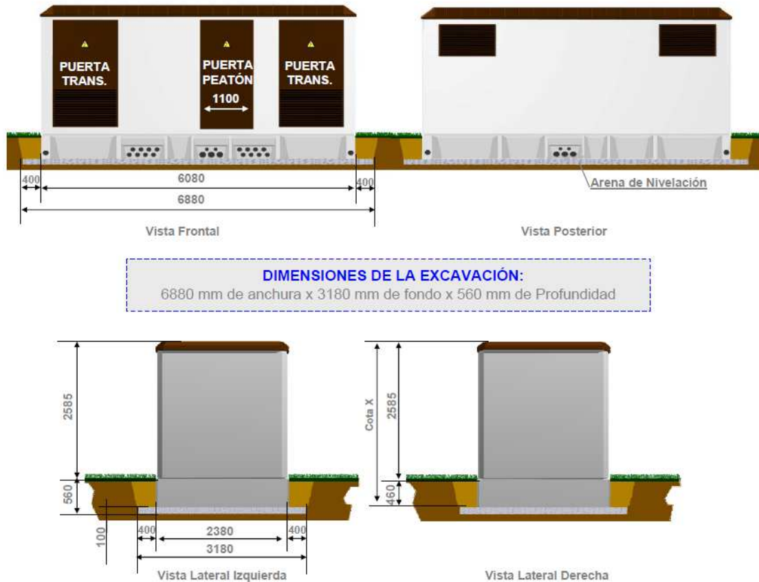
Figura 3. Plano de excavación PFU-5
