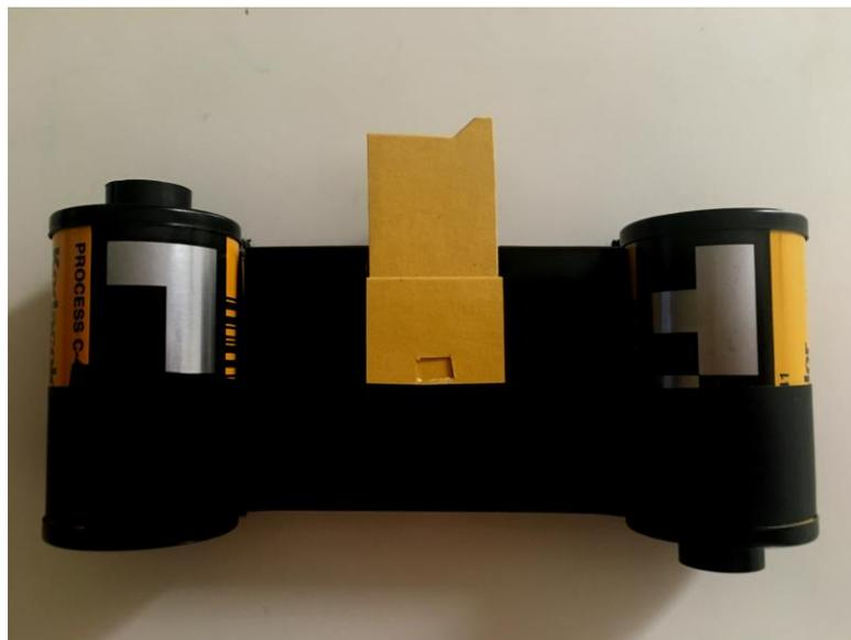
Fig.31. Fijación de los carretes y cobertura de la cámara con cinta aislante negra.
