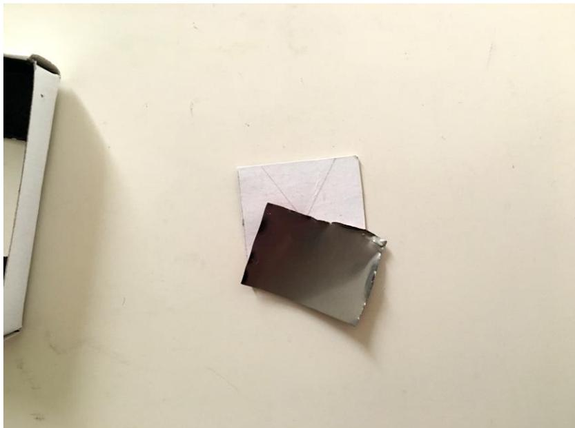
Fig.23. Obtención y recorte del fragmento de lata de refresco de 1,5x1,5 cm.
