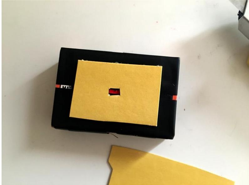
Fig.26. Colocación de la primera pieza de cartón recortada el orificio por el que pasará la luz del exterior a la película.
