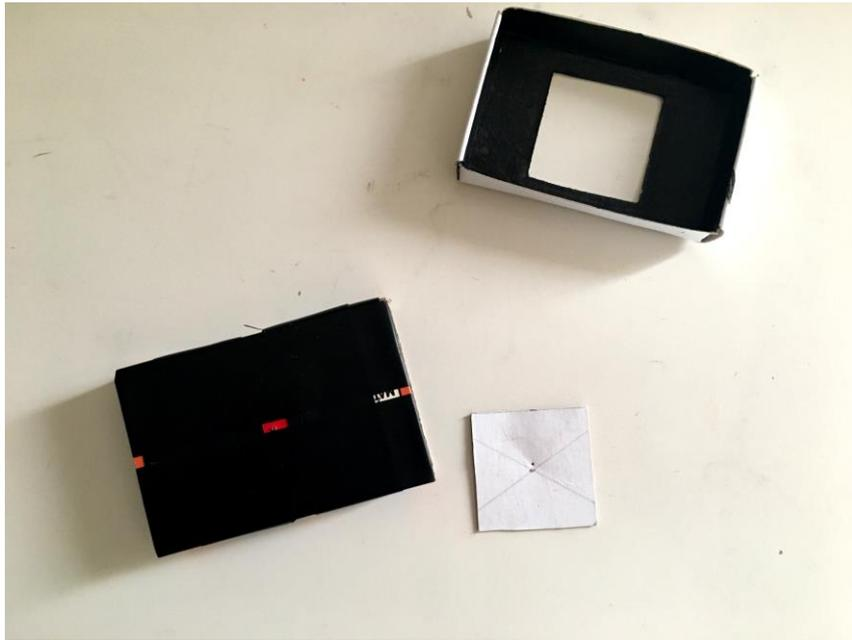
Fig.22. Cobertura del interior de la parte extraíble con rotulador negro y de la parte externa con cinta aislante negra.
