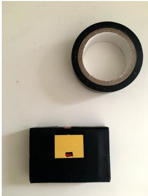
Fig.27. Añadido de la pieza de cartón a la estructura de la cámara estenopeica con cinta aislante negra.
