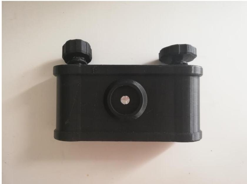
Fig. 3. Cámara estenopeica impresa en 3D.
