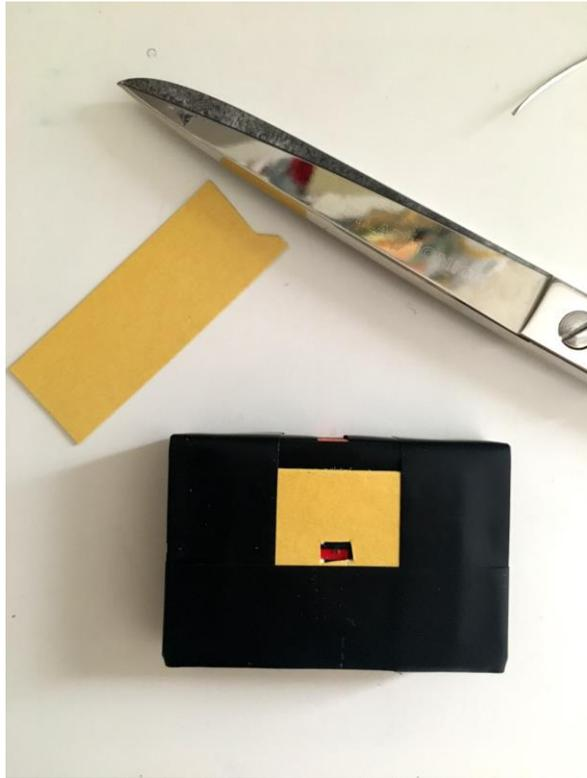
Fig.28. Recorte de la segunda pieza de cartón para cubrir la apertura del orificio.
