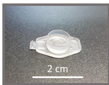
Figura 3. Molde cilíndrico de aproximadamente 8 mm de diámetro que se utiliza, cargado con 100 \mu L de hidrogel de T-A (altura 1,5 mm), para realizar los estudios de estabilidad in vitro .
