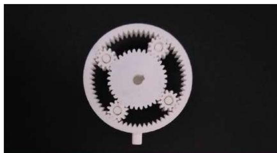
Subconjunto de la multiplicadora ensamblado tras corregir algunos errores de impresión
