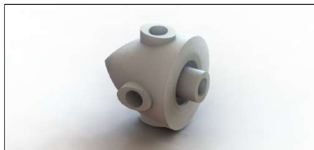
Figura 17: Prototipo de Buje 3 con capacidad para cuatro aspas
