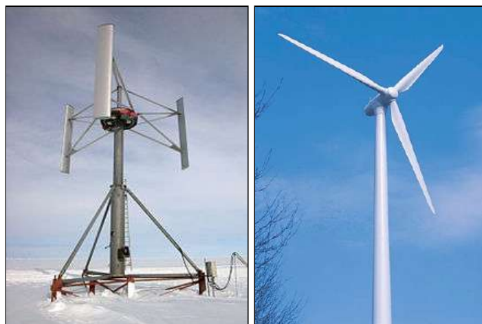
Figura 10: Aerogenerador de eje vertical tipo Darrieus en la Antártida junto a un ejemplo de aerogenerador de eje horizontal común.
