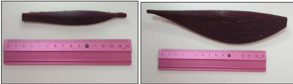
Figura 31: Resultado de la impresión de los prototipos de aspa 1 y 2 respectivamente
