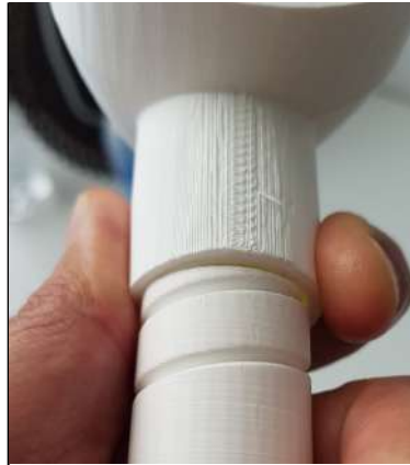
Problema de acoplamiento torre-góndola debido a imprecisión de las impresiones
