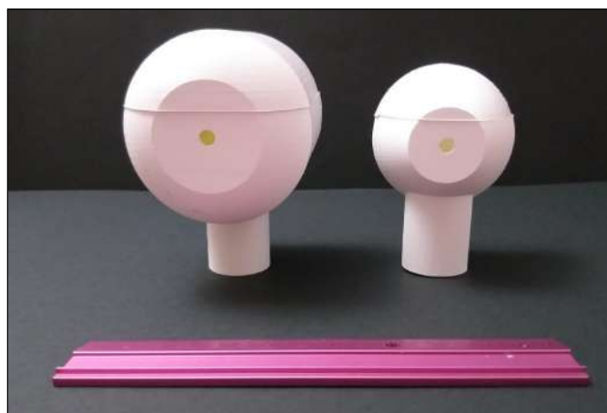
Figura 59: Resultado de la impresión de la góndola de continua para el motor pequeño y la góndola de alterna.
