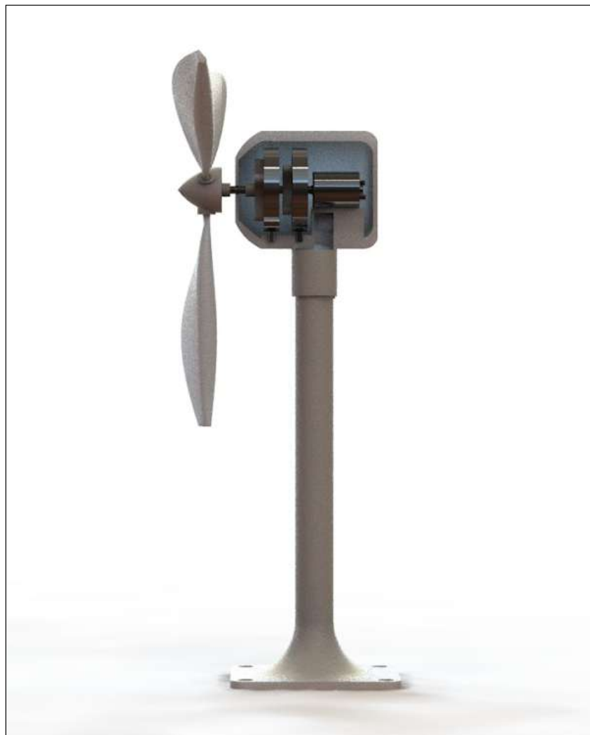
Figura 53: Simulación ensamblaje completo generador DC con aspas 1 y buje de 3 aspas
