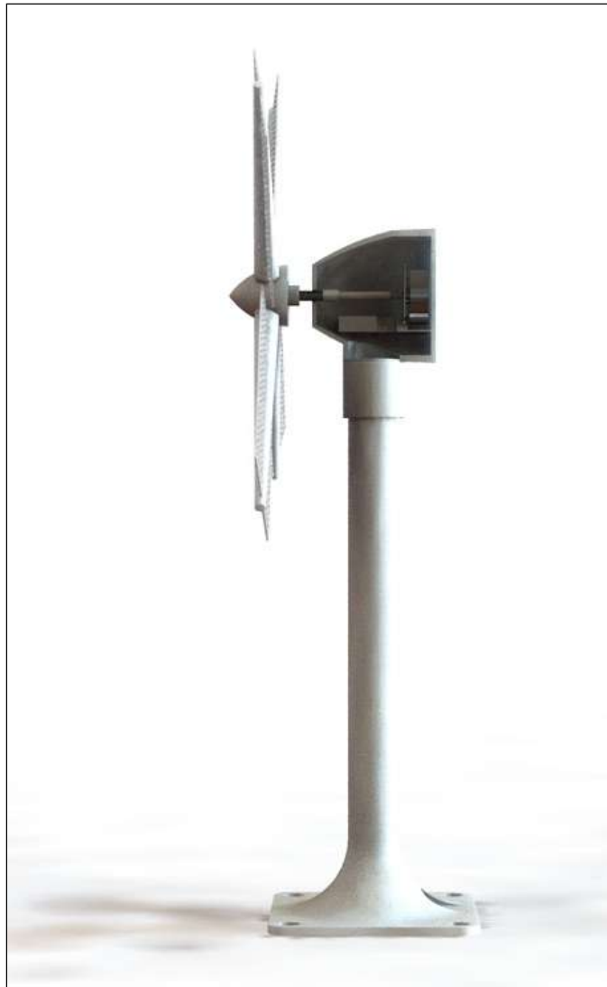
Figura 54: Simulación ensamblaje completo generador AC con aspas 2 y buje de 4 aspas
