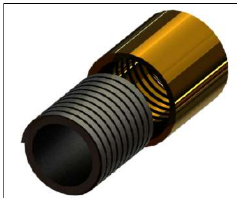
Figura 37: Render manguito y varilla hueca roscada
