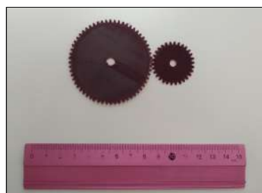
Figura 34: Resultado de la impresión de los prototipos de trenes de engranajes
