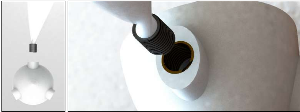
Figura 36: Simulación en SolidWorks del acoplamiento aspa-buje mediante manguito y varilla roscada.
