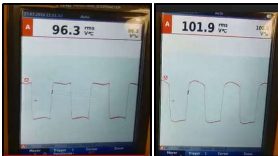
Figura 95: Señal sin picos de tensión pero con variaciones de cuadrada a sinusoidal
