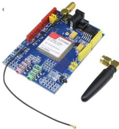
Imagen 34: Modulo SIM 900 GSM/GPRS Fuente: www.es.aliexpress.com
