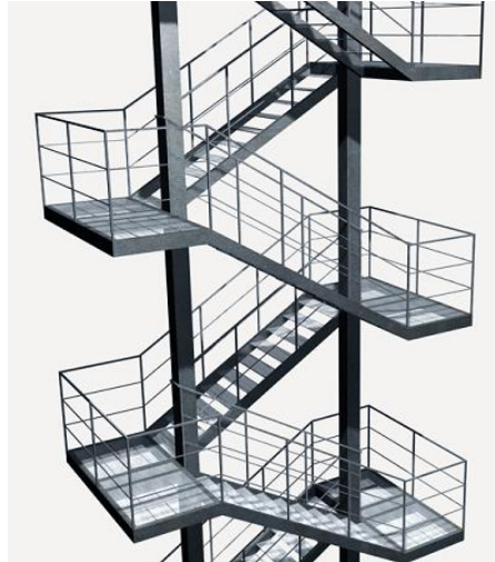
Fig. 3. Escaleras metálicas propuestas. Fuente: Steel-pro, Rusia
