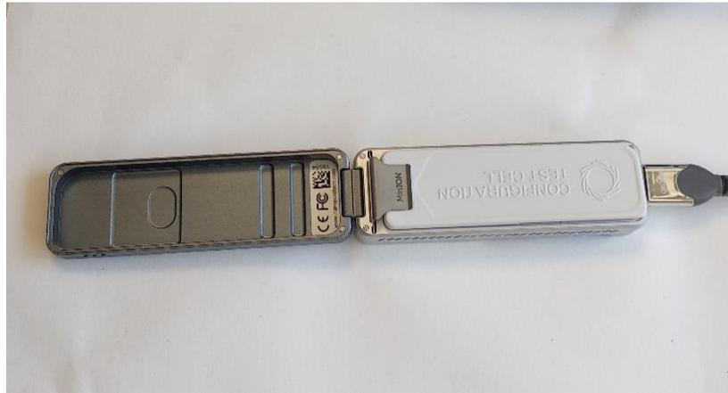
Ilustración 2: aspecto superior del MinION. Debajo de la cubierta blanca se encuentra la “flow cell”.
