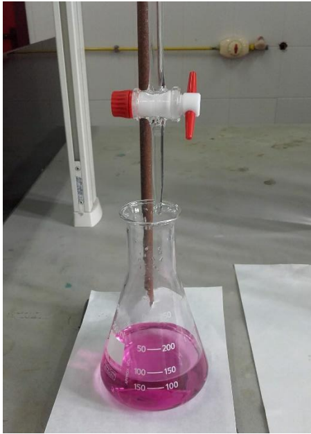
Imagen 5. Muestra antes de la valoración con EDTA.
