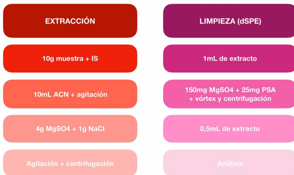
Figura 1.2. Esquema del método QuEChERS original.
