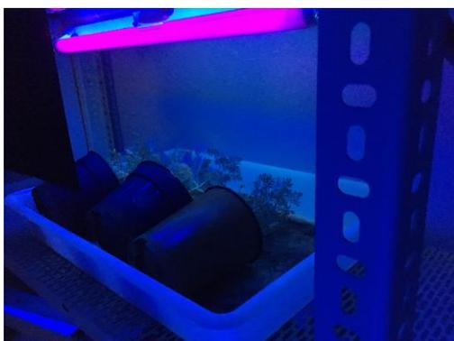
**Figura 11.** Fuentes de luz ultravioleta de los ensayos utilizados: Lámpara de luz blanca acoplada a una lámpara de luz UV (Philips TL-D 18W1SL).
