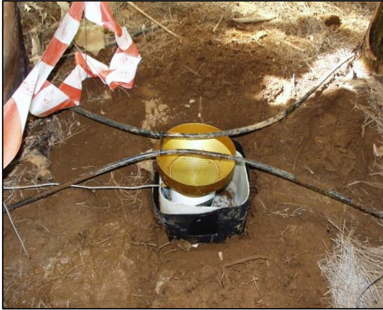
Fotografía 2: Pluviómetro empleado para la recogida del volumen de riego. Fuente: Proyecto IDEASS (SC99-024-C2)
