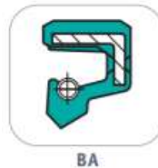
Figure 23: Sección del retén radial modelo BA del fabricante Epidor. Fuente: Catálogo Epidor Seals and Rubber Technology.
