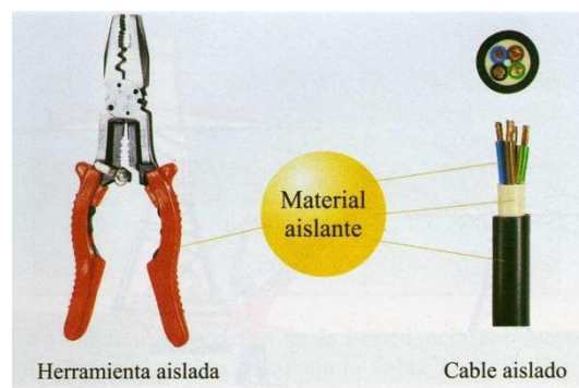
Ilustración 8: Ejemplos de aislamiento de las partes activas
