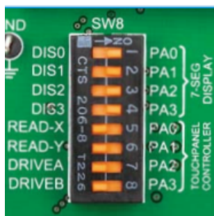
Figura 3.1.3 Configuración del SW8 para el uso del display a 7 segmentos.
