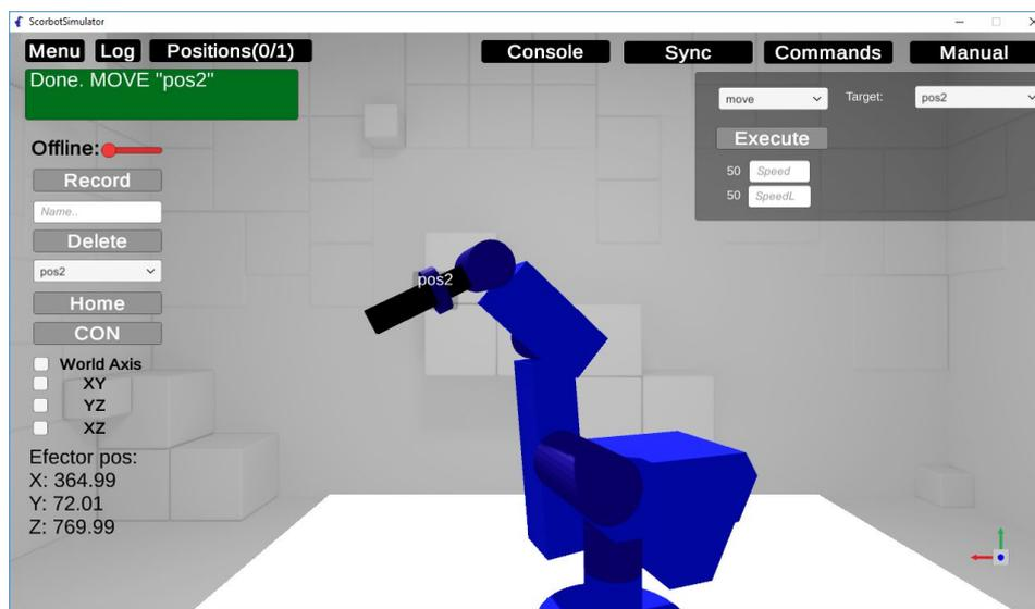
Figura 6.12: Movimiento del Scrobot hacia una posición mediante el comando “*move*”.
