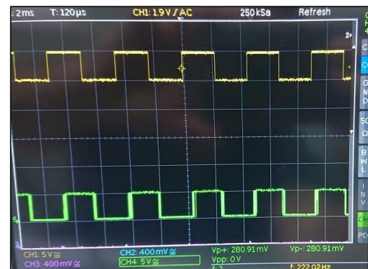
Fig. 44: señales en el comparador de salida II.
