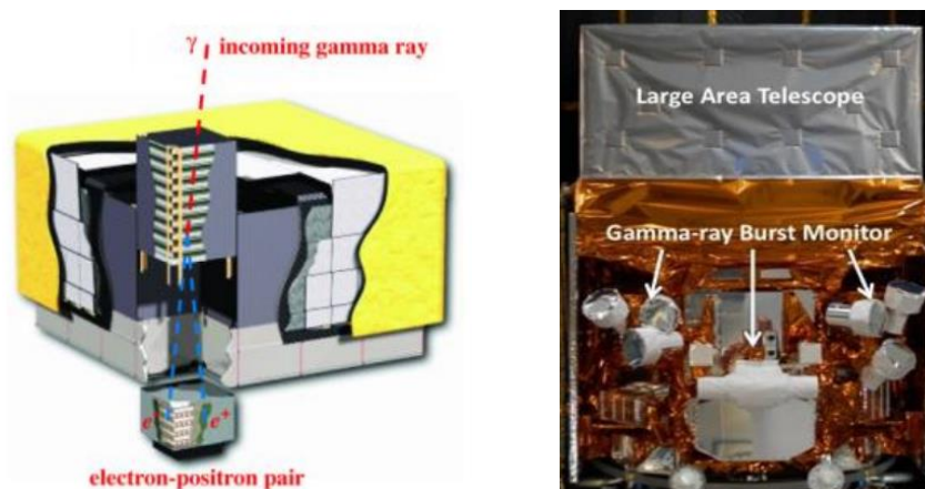
Fig. 8: Izquierda: Esquema de la parte interna del LAT. Derecha: Ambos instrumentos del telescopio de Rayos Gamma Fermi. Obtenido en: https://www.glast.stanford.edu/instrument.html
