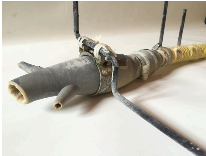
Figura 1 y 2: Molde 3D realizado por Franc Cordeiro. Tras pasar por su interior, durante tres meses y 15 días, el agua del canal ubicado en Tierra del Trigo, se formó una petrificación lo suficientemente fuerte como para permitir extraer el objeto-souvenir mediante eliminación mecánica del molde.
