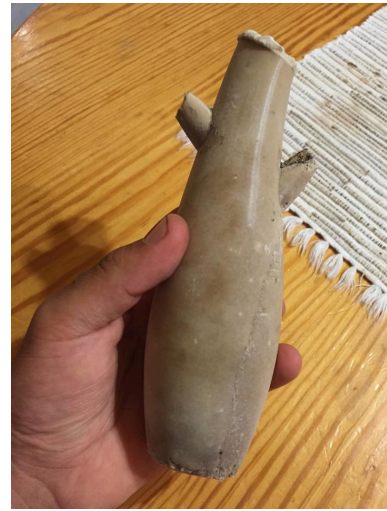
Figura 1 y 2: Molde 3D realizado por Franc Cordeiro. Tras pasar por su interior, durante tres meses y 15 días, el agua del canal ubicado en Tierra del Trigo, se formó una petrificación lo suficientemente fuerte como para permitir extraer el objeto-souvenir mediante eliminación mecánica del molde.
