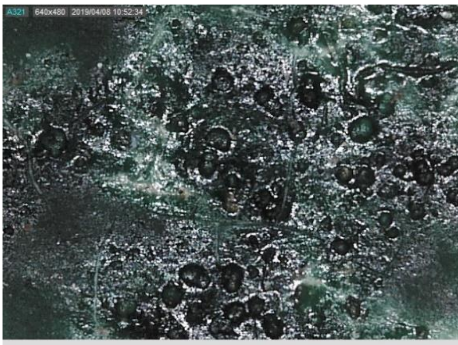
Figura 8. Fotografía con microscopio digital con 210x del biodeterioro en la zona verde
