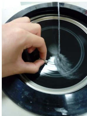
Fig. 47 Proceso de desbastado de la superficie de las probetas
