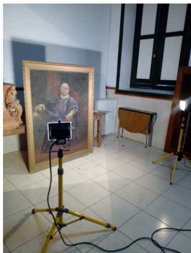
Fig. 32 Fotografía del montaje fotográfico utilizado para la toma de fotografías IR y Generales VIS
