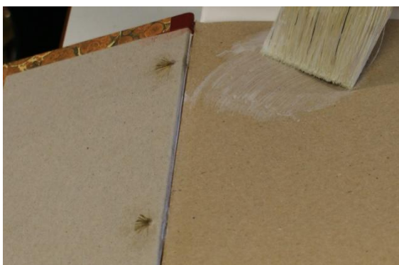
Figura 56.- Encolado de guarda. Imagen del autor.
