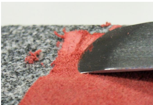
Figura 51.- Chiflado de la piel. Imagen del autor.
