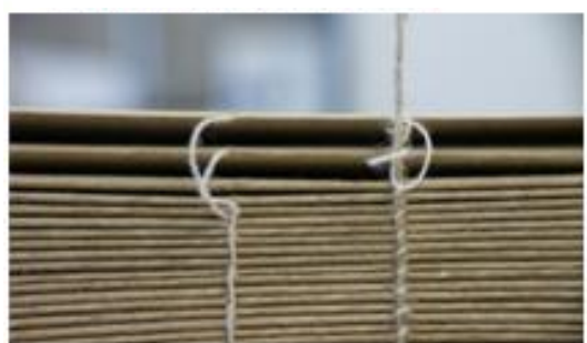
Figura 33.- Cadeneta en el lado izquierdo. Imagen del autor.
