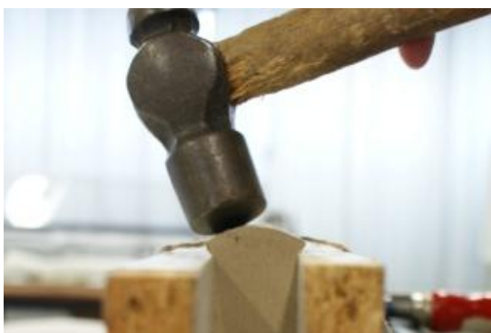
Figura 38.- Sacado de cajos. Imagen del autor.
