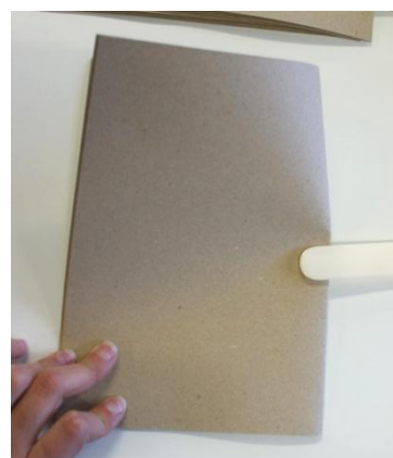
Figura 27.- Marcado del plegado en sentido ascendente. Imagen del autor.
