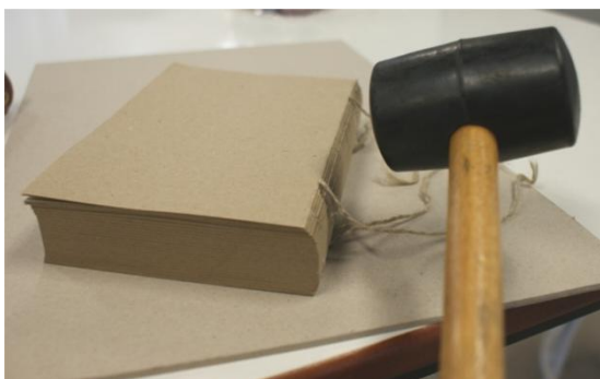
Figura 36.- Redondeado del lomo. Imagen del autor.
