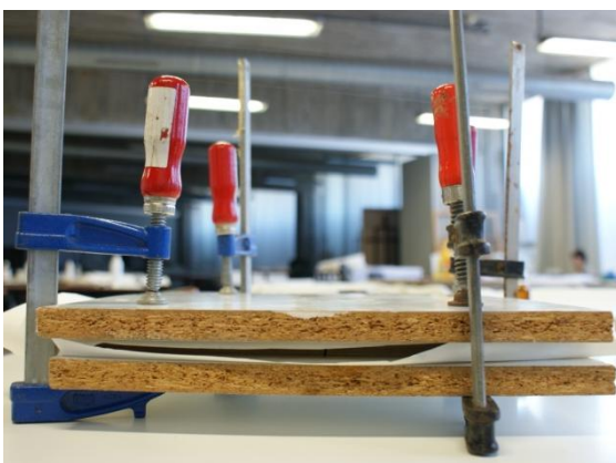
Figura 29.- Prensado de cuadernillos. Imagen del autor.
