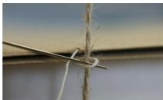
Figura 31.- Enlace de los dos primeros cuadernillos. Imagen del autor.
