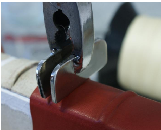
Figura 54.- Marcado de los nervios con pinzas. Imagen del autor.
