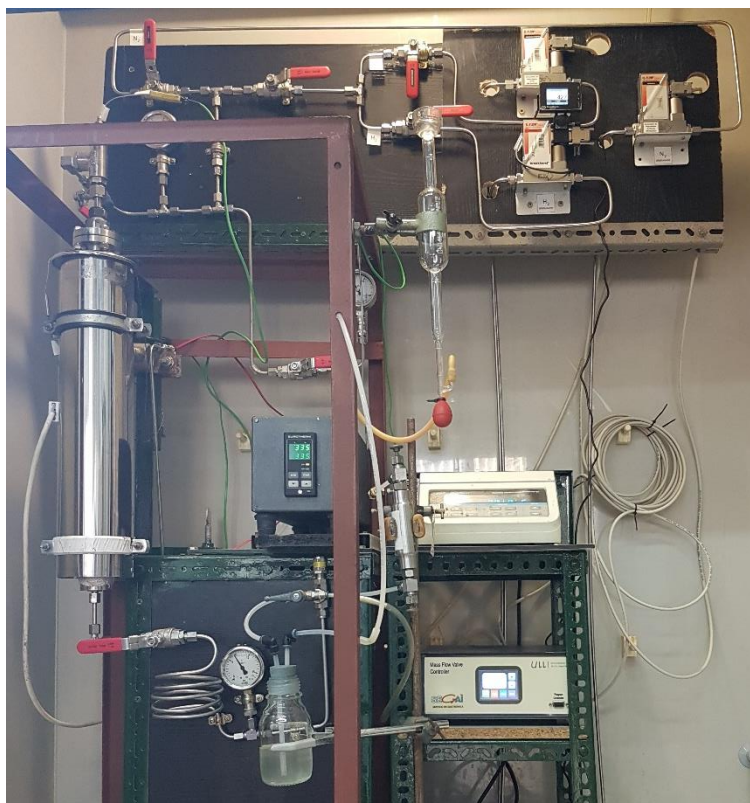
Figura 3. 9. Sistema obtención DME por hidrogenación de CO 2 .
