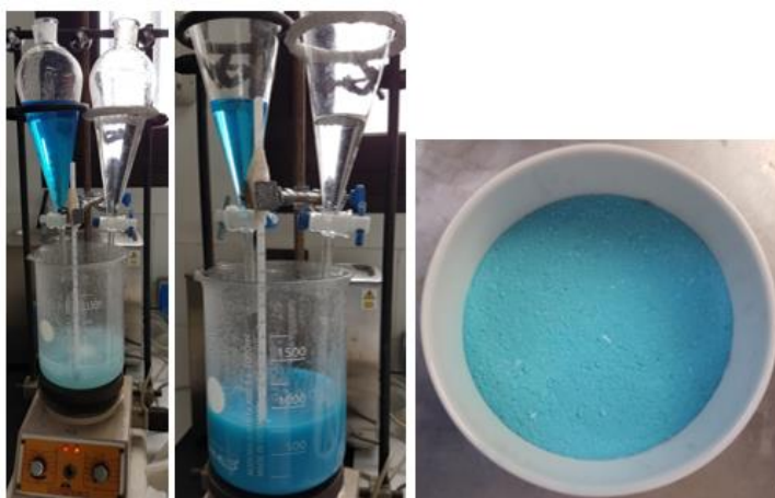
Figura 3. 3. Catalizador polimetálico Cu:Mg:Al (seco).
