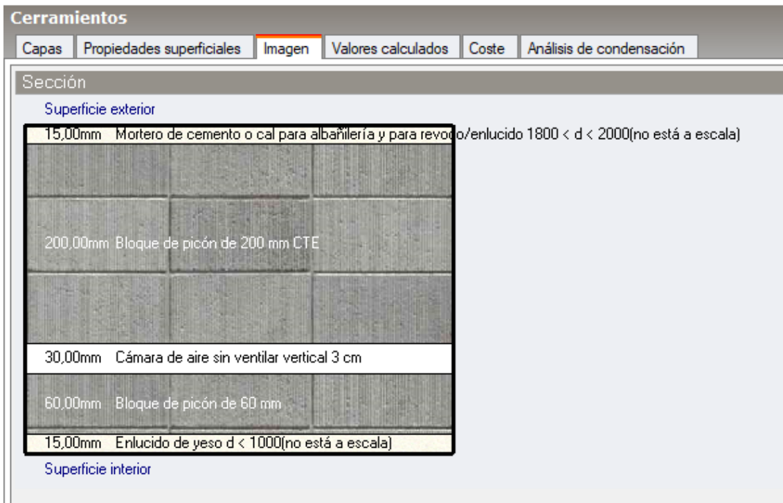
Figura 45. Cerramiento de fachada DesignBuilder. Fuente: Elaboración propia.
