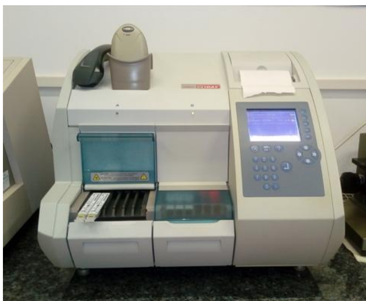
Figura 3. Equipo VIDAS 25 OH Vitamina D TOTAL de Biomérieux
