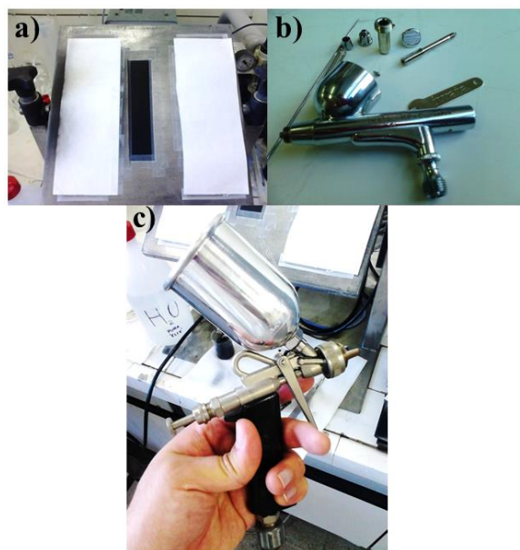
Figura 4.17. a) Placa con temperatura para el pintado de los electrodos, b) tipos de aerógrafos y c) pistola de aire comprimido empleados para el proceso de pintado por spray.
