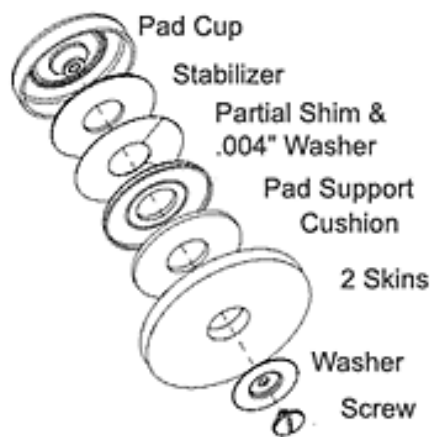
Imagen 98. Partes de una zapatilla Straubinger.
