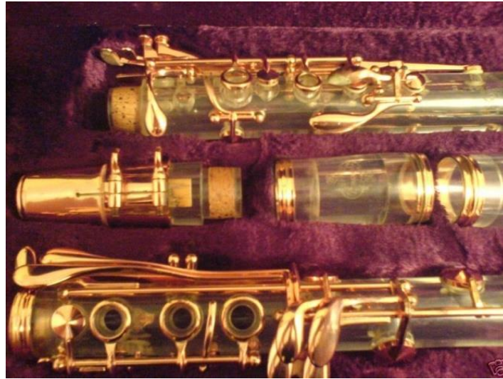
Imagen 68. Clarinete desmontado fabricado en PMMA transparente.
