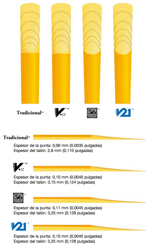
Imagen 40. Ejemplos de diferentes formas del biselado de una lengüeta 39
