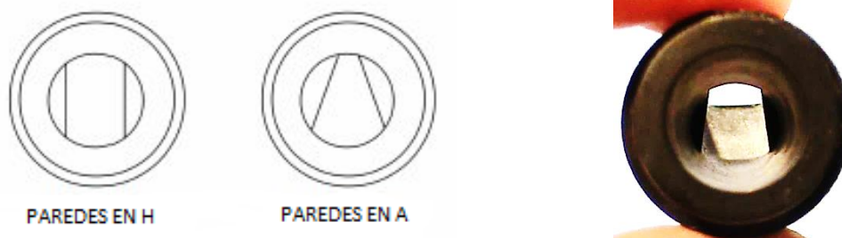
Imagen 130. Izquierda: diagramas con las dos formas básicas que puede tomar la anchura. Derecha: boquilla vista desde abajo. Se puede ver la forma de A. Obsérvese que la ventana está vuelta hacia arriba.
