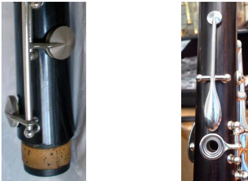
Imagen 90. Izquierda: el brazo hace las funciones del eje. Derecha: el eje es transversal al brazo.
