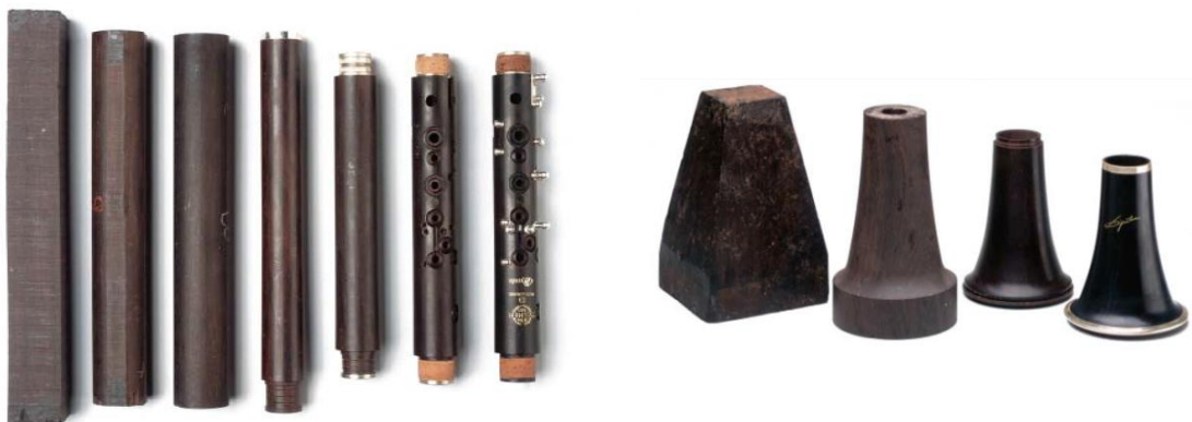
Imagen 62. Pasos para la formación del cuerpo superior de un clarinete (izquierda) y una campana de clarinete (derecha).
