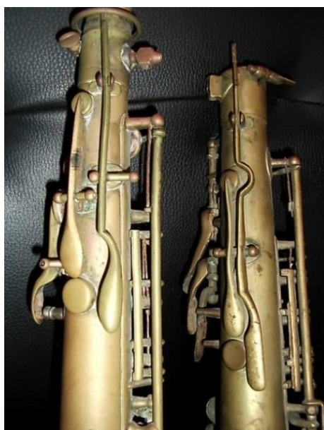
Imagen 149. Izquierda: dobles llaves de registro en saxofones de ca. 1898 (Buffet a la izquierda y anónimo a la derecha). Derecha: única llave de registro automática en un saxofón Yamaha moderno.
