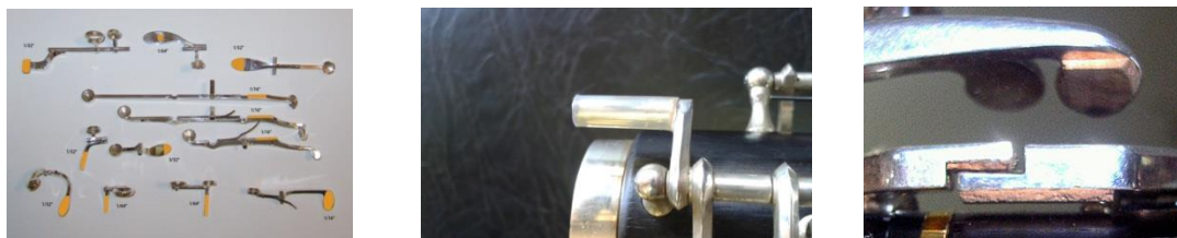
Imagen 116. Izquierda: llaves del cuerpo superior de un clarinete soprano. El material de color amarillo es corcho sintético, pero en los mismos lugares también se puede usar goma o fieltro. Centro: pieza de plástico en forma de pequeño tubo en el cuerpo superior de un clarinete bajo para evitar la holgura entre llaves (esta pieza empujará la llave que abrirá el agujero del tudel). Derecha: detalle de corchos instalados en sus llaves.
