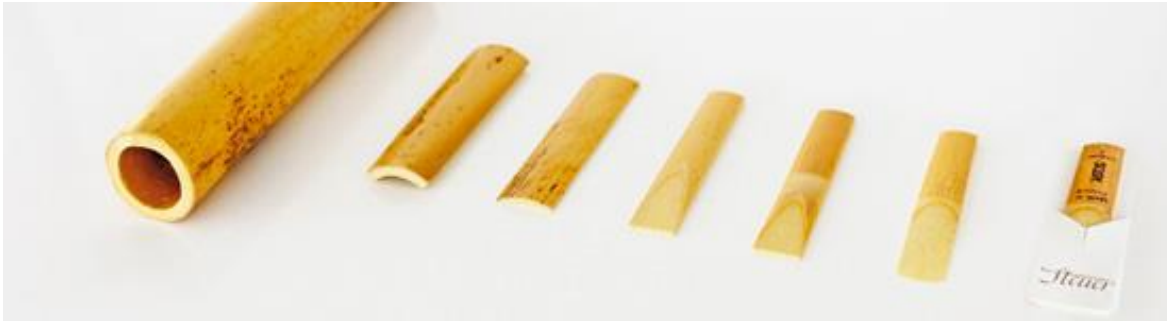
Imagen 41. Fases en la fabricación de una lengüeta.
