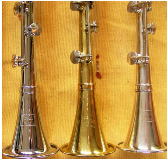
Imagen 78. Detalle de clarinetes de latón en tres acabados. Izquierda: niquelado. Centro: plateado. Derecha: lacado
