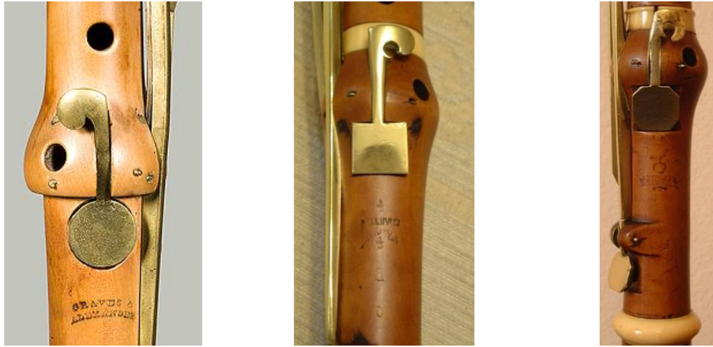
Imagen 94. Diversos diseños adoptados por las palas de las llaves para albergar las zapatillas antes de inventarse las cazoletas. Izquierda: clarinete Graves (ca. 1827-1833). National Music Museum. University of South Dakota. Dakota, EEUU. Centro: clarinete Cuvillier (ca. 1780-1790). Derecha: clarinete Stengel (ca. 1810). NC Clarinet Collection. Arkansas, EEUU.
