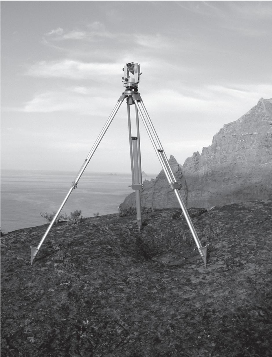
Figura 2: Teodolito portátil TEO-3 dispuesto en estación en el yacimiento de La Pedrera. Al fondo puede observarse el llamativo horizonte oriental donde se ha centrado el estudio.
