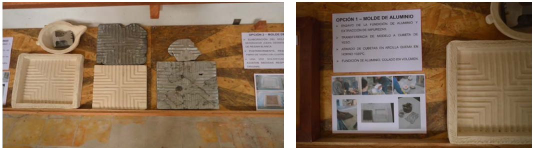
Figura 12: Molde de yeso, de aluminio y baldosa; Registros de los ensayos de la fundición de aluminio y extracción de impurezas, transferencia de modelo a cubeta de yeso y armado de cubetas en arcilla.
