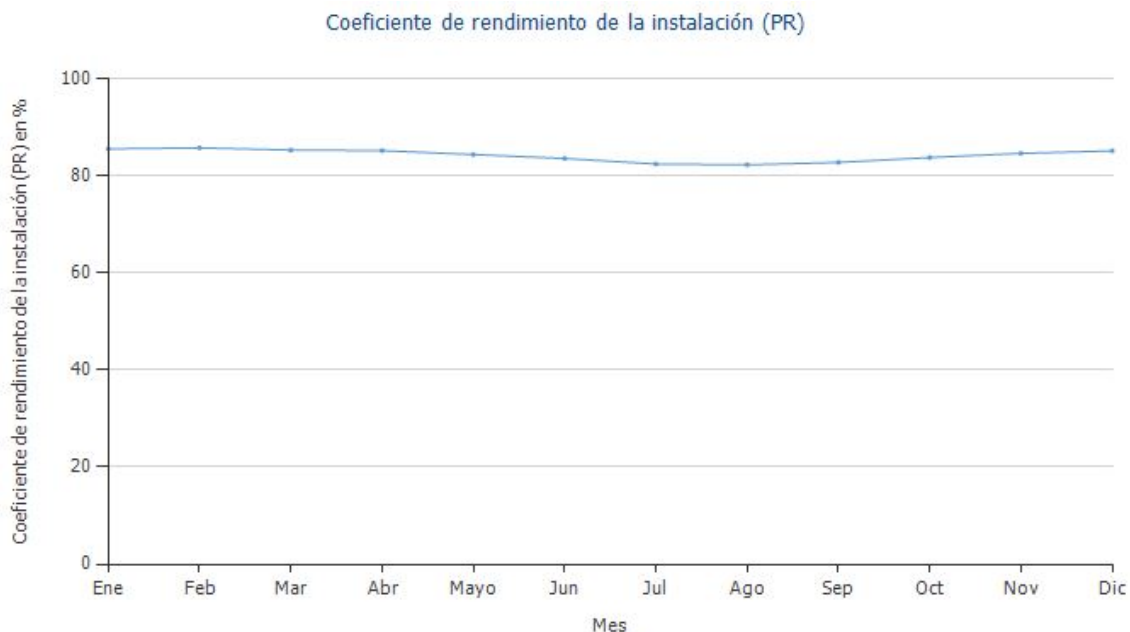
Figura 7 Performance Ratio de la instalación
