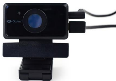
Figura 12: Cámara de infrarrojos de Oculus Rift DK2.
