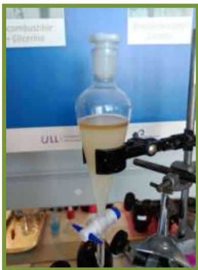
Figura 4.10.- Resultado de la esterificación transcurridas 24 h. de reposo.
