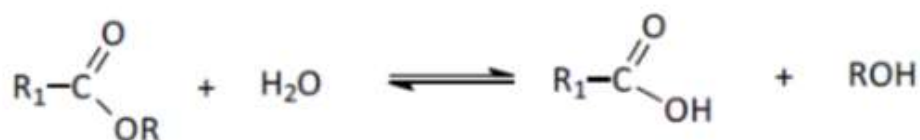
Figura 2.19.- Reacción de hidrolización de los triglicéridos.
