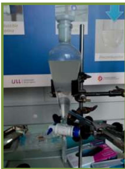
Figura 4.13.- Lavado del biocombustible.
