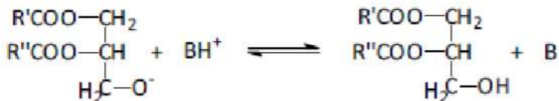
Figura 2.18.- Desprotonación del catalizador y reacción con otra molécula de alcohol.
