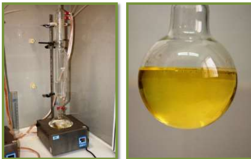
Figura 4.8.- Equipo de recuperación del solvente / Aceite extraído.
