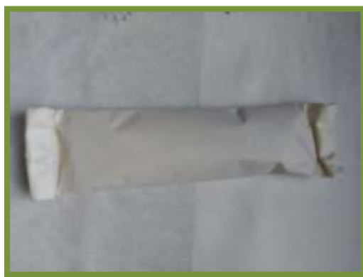
Figura 4.5.- Cartucho de papel de filtro con las semillas trituradas en su interior.
