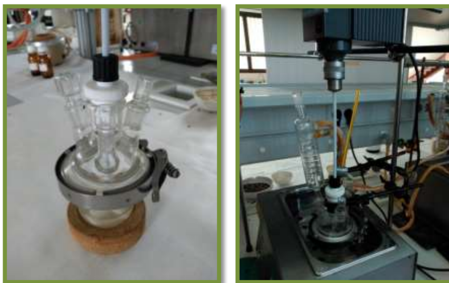
Figura 4.11.- Equipo de transesterificación.
