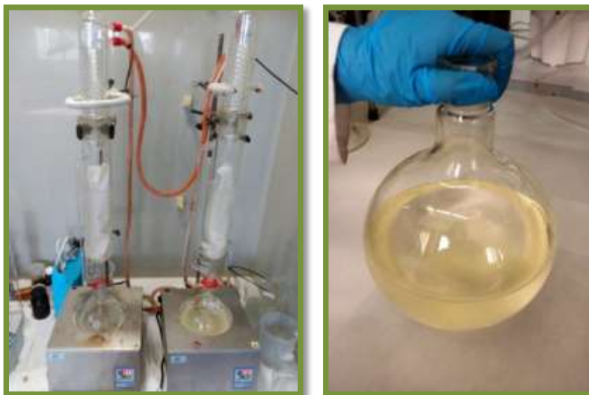
Figura 4.6.- Equipo soxhlet de extracción de aceite / Mezcla hexano-aceite.
