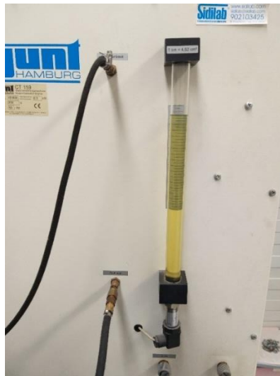
Figura 20: Vista del visor graduado para la medición de consumo de combustible
