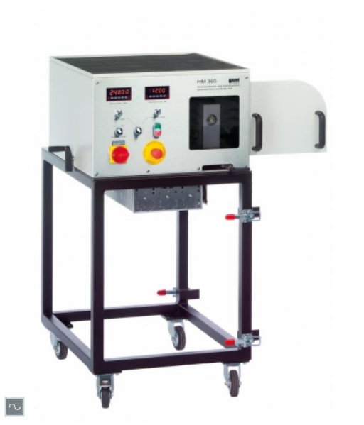
Figura 18: Vista general del módulo de accionamiento y frenado HM 365
