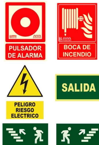
Figura 58. Señales de generales de emergencia.
