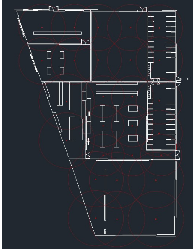
Figura 57. Plano de distribución de detectores de incendio.
