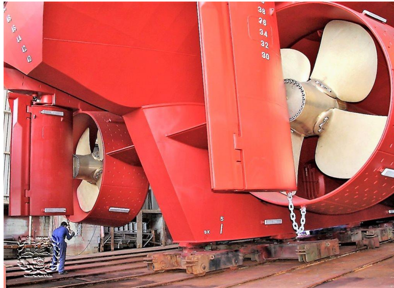
Imagen 7: Hélice con tobera fija tipo Kort y hélice de paso variable
