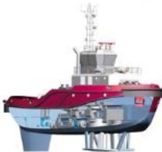
Imagen 9: Remolcador con propulsión cicloidal y Voith Schneider Fin
