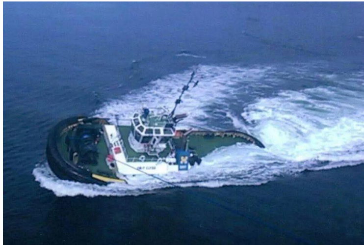
Imagen 24: Remolcador escorado durante el tiro indirecto
