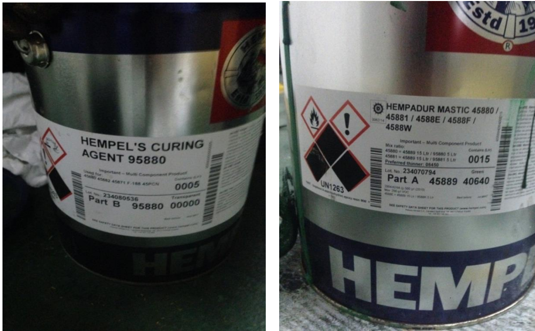
Ilustración N°27: Aquí vemos la PARTE A 45889 que es el verde 40640 y su parte B HEMPEL'S CURING AGENT 95880 PART B
