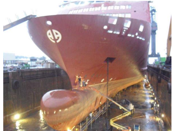
Ilustración 70: Fregado y Preparación Mecánica de Costados
