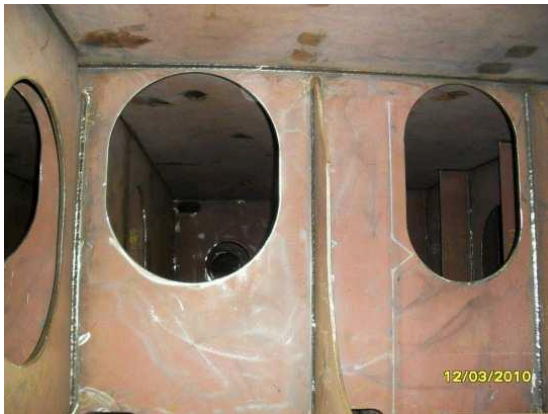
Ilustración 49.50: Preparación superficie y pintado HEMPADUR QUATTRO (nº 17634 – 50630) espacios vacíos.
