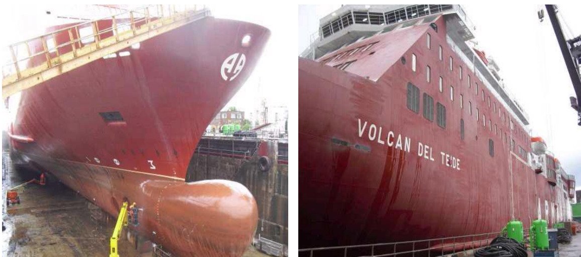
Ilustración 60: Estado a la llegada y Fregado con Agua dulce
