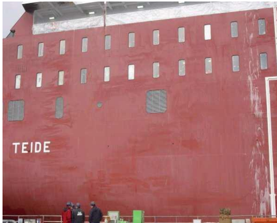
Ilustración 70: Fregado y Preparación Mecánica de Costados
