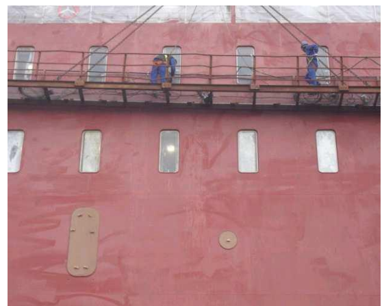
Ilustración 71: Costado con daños y quemaduras Sa2 y lijado de ventanas
