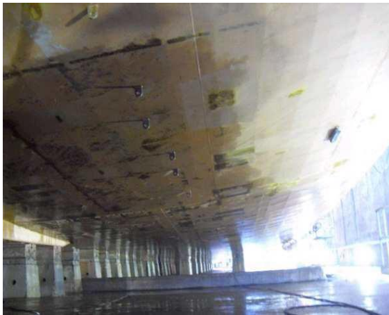
Ilustración 61: Preparación superficie Fondo Plano fregado y lijado
