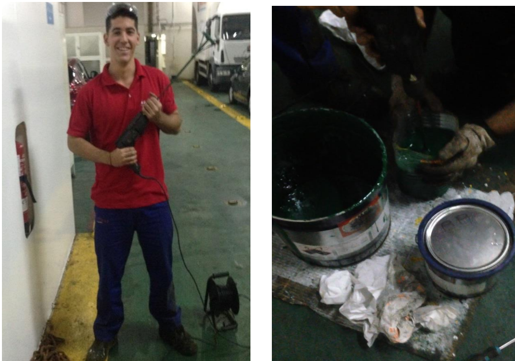
Ilustración N°28: Mezclador de pintura y realización de mezcla
