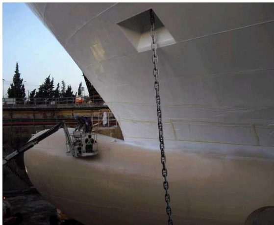
Ilustración 65: Lijado del Bulbo tras pintar costados y protección del costado.
