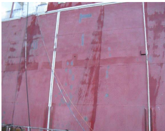
Ilustración 71: Costado con daños y quemaduras Sa2 y lijado de ventanas
