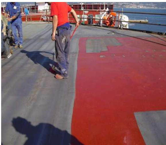
Ilustración 57: Aplicación a rodillo (izq) y pistola (dcha) capa HEMPADUR QUATTRO (n° 17634 – 50630)
