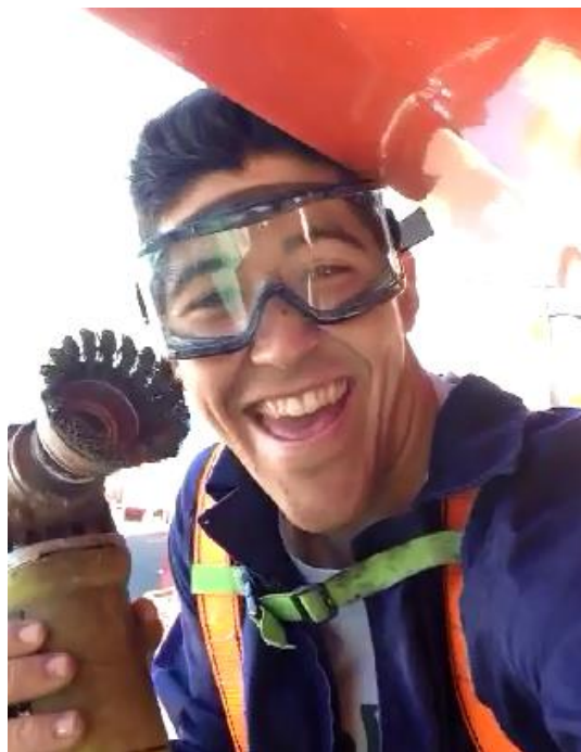
Ilustración N°31: Radial con cepillo de alambre de acero
