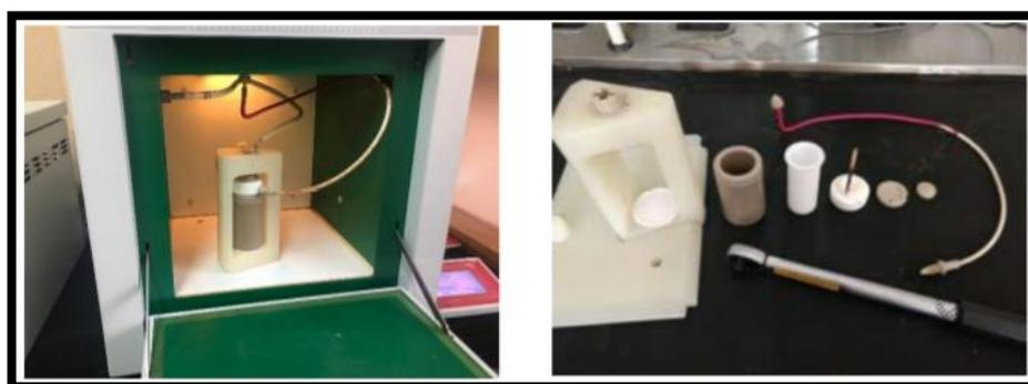
*Figura 20: A la izquierda se muestra el microondas Milestone Ethos Touch Control, y a la derecha el reactor con el resto de sus componentes para introducir la muestra.<sup>42</sup>*
