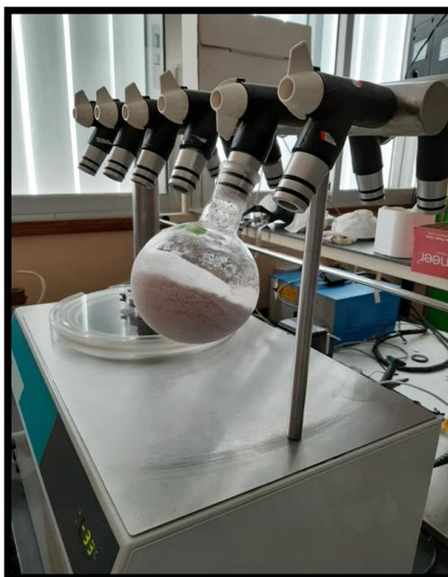
*Figura 23: Muestra liofilizada secándose en Liofilizador Heto Lyolab 3000.*
