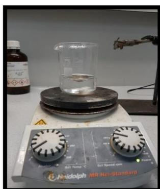
*Figura 19: Disolución de EDTA +  $\text{C}_6\text{H}_8\text{O}_7$  disolviéndose con ayuda de un agitador magnético*
