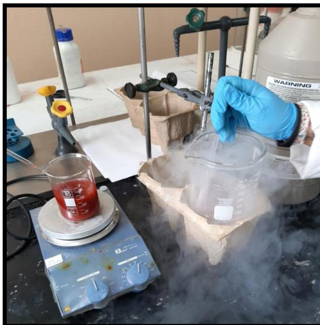
*Figura 22: Proceso de liofilización.*
