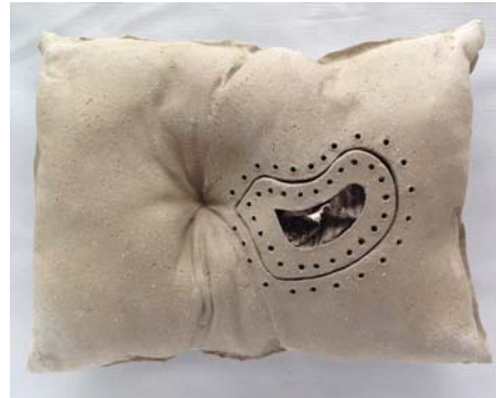
Imagen XXXVIII: Realizacion de huecos en el cuerpo cerámico de las diferentes piezas y los orificios perimetrales de los mismos
