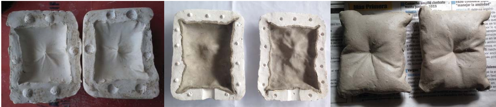
Imagen XXXV: Proceso de elaboración serial a partir de molde rígido
