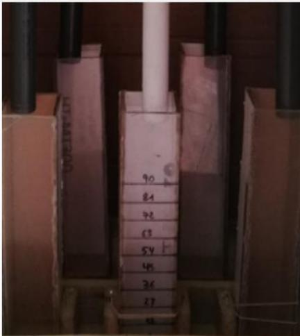
6. Los contadores irán colocados sobre una superficie de madera que se ajusta a la base de la caja. Estarán sujetos con elásticos bajo el tubo correspondiente.
