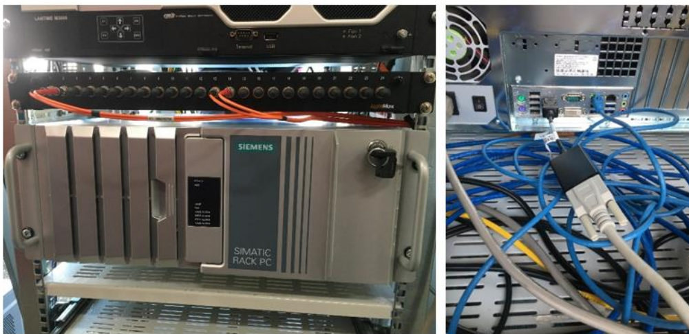
Figura 29 SIMATIC IPC547G (izquierda) y conectores Ethernet y VGA - HDMI al PC Concentrador (derecha)
