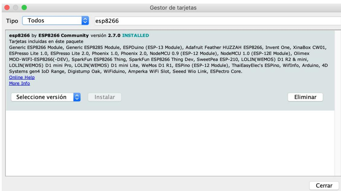
Figura 3.2. Soporte para ESP8266 en el IDE Arduino.
