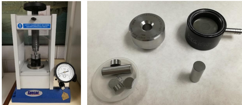
Figura 15. Prensa hidráulica Atlas™ Specac (izquierda) y molde ICL de 13 mm (derecha).
