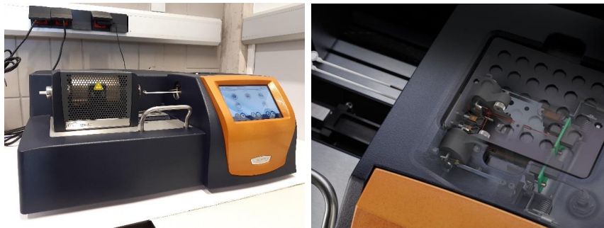
Figura 25. Analizador Térmico Simultáneo SDT650 de TA Instruments (izquierda) y detalle de la termobalanza del analizador térmico (derecha) [61].
