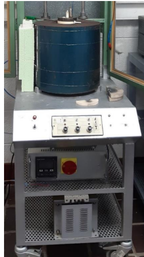
Figura 18. Horno utilizado para calentar la muestra durante el ensayo de espectroscopía de impedancias.
