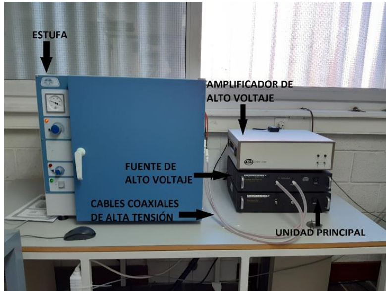
Figura 19. Equipo para medidas de ciclo de histéresis: en la parte derecha de la imagen de abajo hacia arriba se encuentran la unidad principal de control Precisión LC, la interfaz de alto voltaje (HVI) y el amplificador de alto voltaje (HVA). En la parte izquierda de la imagen se puede observar la estufa donde se introdujo la muestra para realizar las medidas a diferentes temperaturas.
