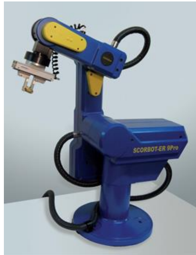
Fig. 2: Ejemplo robot de trayectoria manipulable. Robot SCORBOT-ER 9 PRO Fuente: página de ORPI
