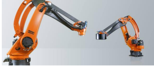
Fig. 1: Ejemplo robot secuencial. Robot paletizador KUKA. KR 40 PA Fuente: página de kuka
