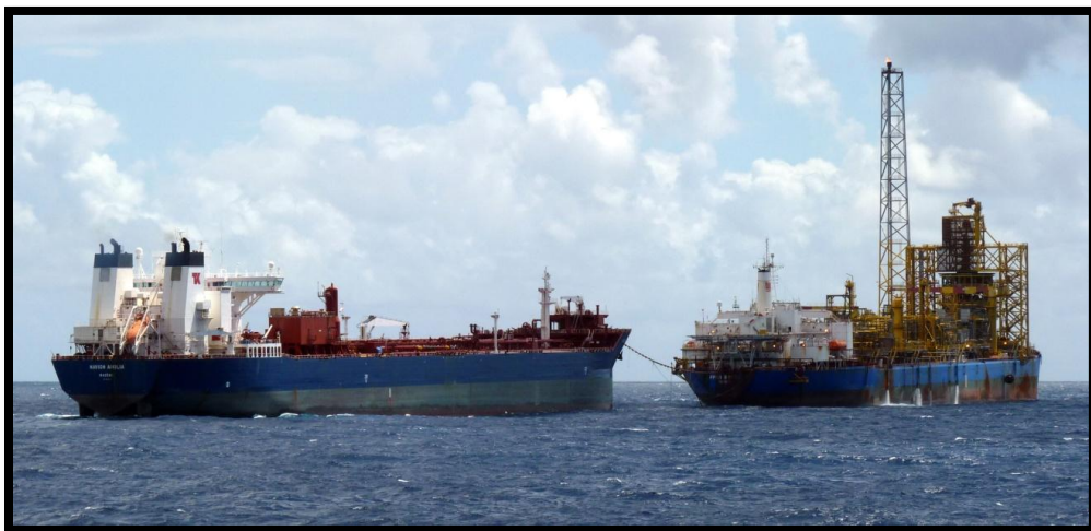
Imagen 9: Shuttle Tanker realizando maniobras de carga de crudo desde un FPSO.
