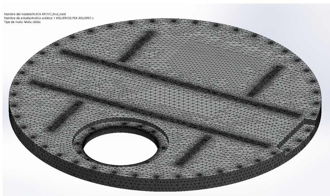
Figura 12. Ejemplo de mallado fino para el estudio de la placa.
