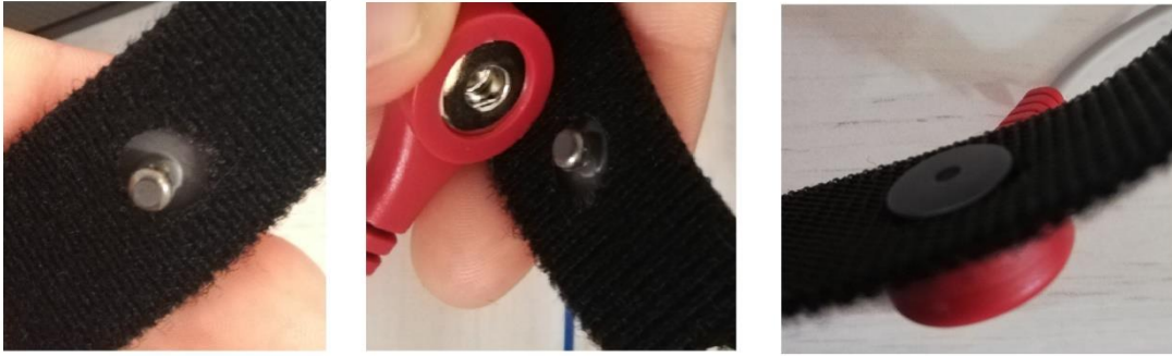
Figura 24 Procedimiento cables rojo y blanco para electrodos planos.
