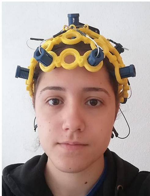
Figura 39 – Ejemplo de montaje sistema de 8 electrodos en casco Ultracortex
