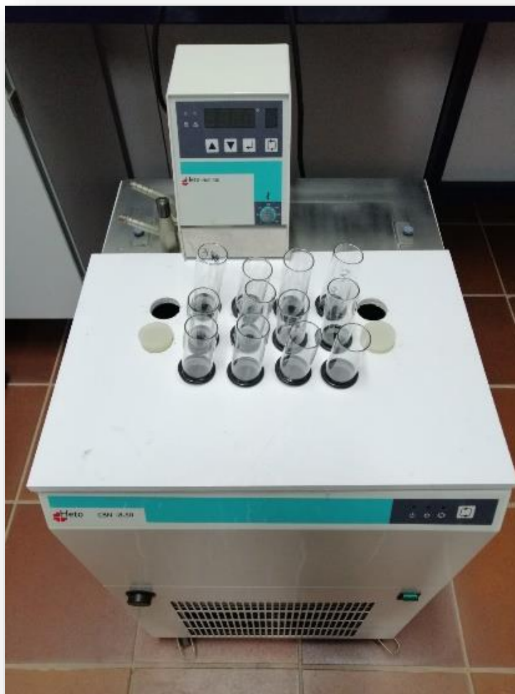
Fig. 11- Termostato con sistema de soporte para tubos de ensayo. Para la realización de las medidas, cada una de las disoluciones fueron dispuestas en tubos de ensayo grandes. Se llevaron a temperatura simultáneamente en bloques de 13 (10 muestras de una misma concentración de disolvente agua-alanina, 2 disoluciones blanco (sólo disolvente) y 1 muestra blanco de agua Milli-Q ). Para poder alcanzar la temperatura deseada de manera homogénea y simultánea, se diseñó un sistema de soporte de plástico rígido ( figura 11 ) para mantener los tubos debidamente sumergidos. Gracias a esto, todas las medidas fueron tomadas en las mismas condiciones.
